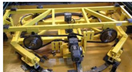
Mesa rotoelevadora · diseño propio Stellantis · 2018
